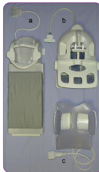
Figure 2 : Trois modèles d'antennes : (a) antenne « rachis », (b) antenne « tête et cou » en forme de heaume, (c) antenne « seins » utilisée en décubitus ventral, seins positionnés dans les alvéoles blanches.
